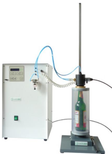
Прибор служит для автоматического насыщения напитков, розлитых в стеклянные и ПЭТ-бутылки. Прибор предназначен для индивидуального насыщения образцов напитков необходимым количеством CO<sub>2</sub>. Наличие регулировки степени насыщения CO<sub>2</sub> в широком интервале, обеспечивает возможность получения для Заказчика напитка с необходимым содержанием углекислоты.
